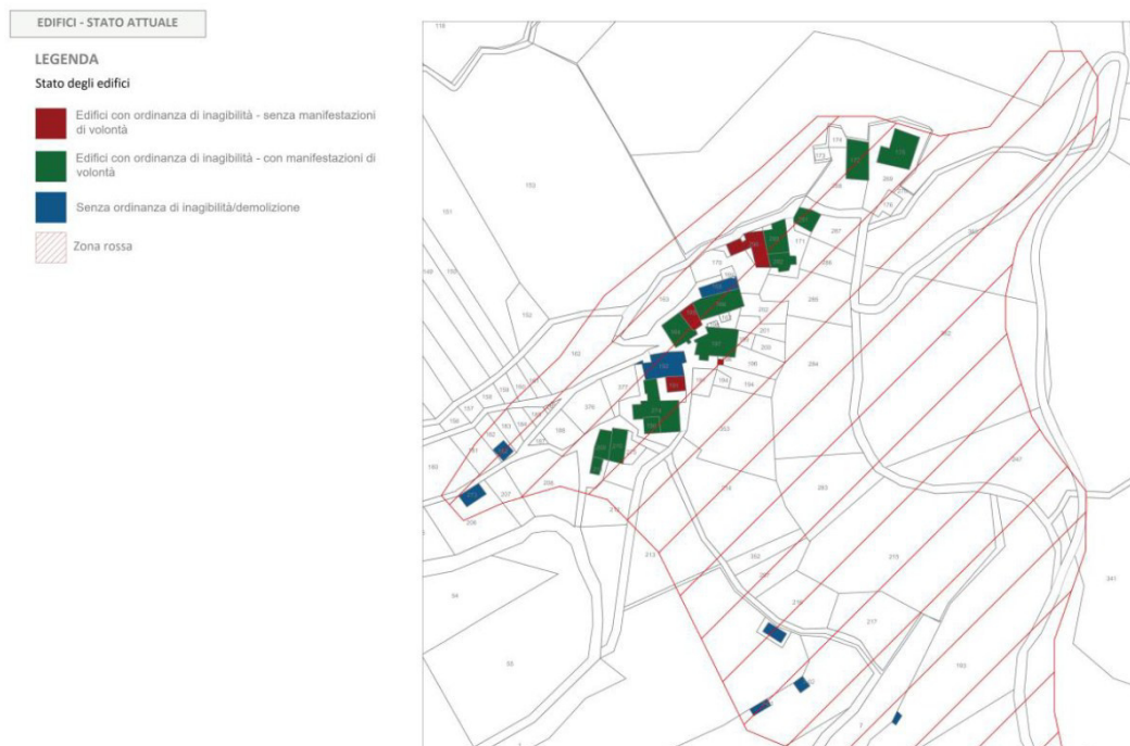
Fig. 3 - La planimetria, estratta dal PSR, mostra lo stato di inagibilità degli edifici (distinti sulla base delle manifestazioni di volontà a ricostruire), della perimetrazione della zona rossa.
